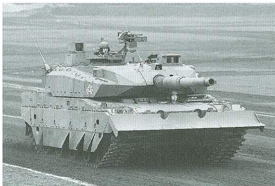
■フロントにドーザーが取り付けられた、10式戦車試作3号車。 ■Prototype No.3 fitted with front dozer blade.
